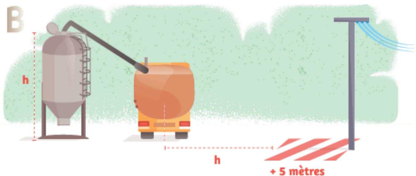
Lorsque les **distances horizontales** ci-dessus **ne peuvent être respectées**, la ligne électrique doit alors être à une hauteur minimale de  **$H + 5 \text{ m}$**
