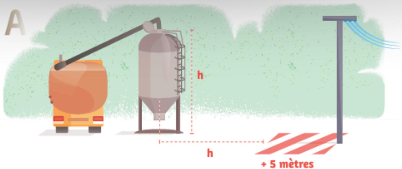
Si le **chemin d'accès** du véhicule de livraison est situé **entre la ligne électrique et le silo**, la distance entre la ligne électrique et le véhicule doit être au moins **égale à la hauteur du silo (H)** augmentée de 5 mètres
